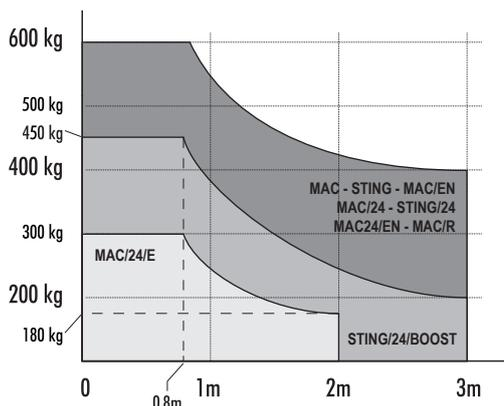
**UWAGA** Jeśli długość skrzydła przekracza 2 m lub wykorzystywane są modele odwracalne, należy zainstalować elektrozamek w celu zablokowania bramy na zamknięciu.
